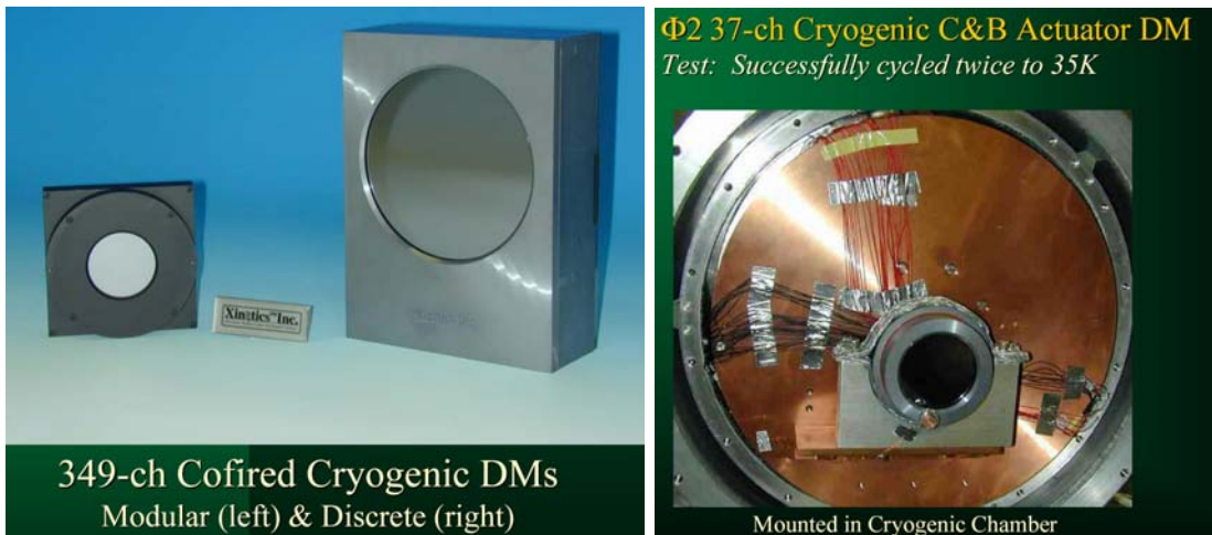
図 5.31: 米国 Xinetics 社で開発中の極低温可変形鏡 (Ealey et al. 2002)。
